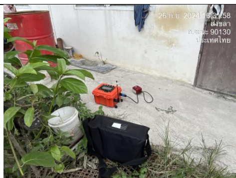
รูป AR ตรวจวัดแรงสั่นสะเทือน และแรงอัดอากาศจากการระเบิด
